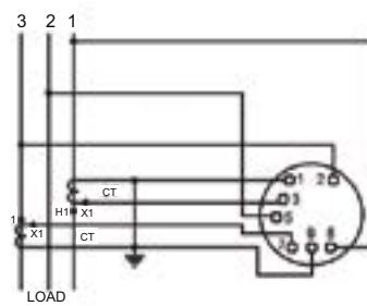
Fig. D2 Models 078-31L VArmetre 3-phase
